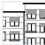
▪ Juntas de dilatación
